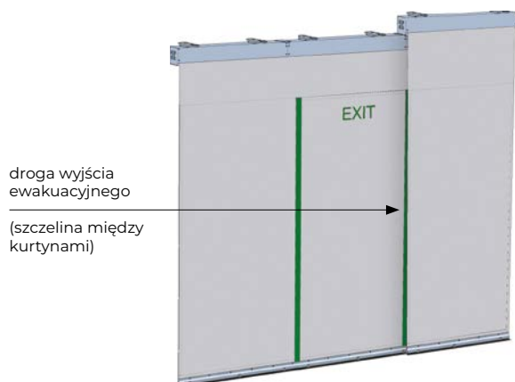
Rys. 35 Wyjście ewakuacyjne wykonane w kurtynach
